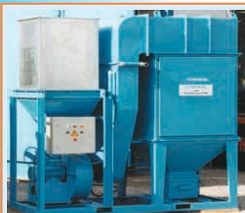
Передвижная фильтровальная установка 5.000 м<sup>3</sup>/час с патронными фильтрами
