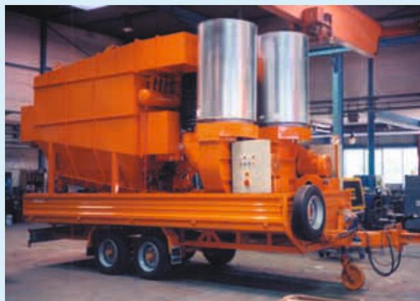
Мобильная установка с патронными фильтрами 2 x 20.000 м<sup>3</sup>/час
