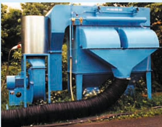
Фильтровальная установка с патронными фильтрами 10.000 м<sup>3</sup>/час
