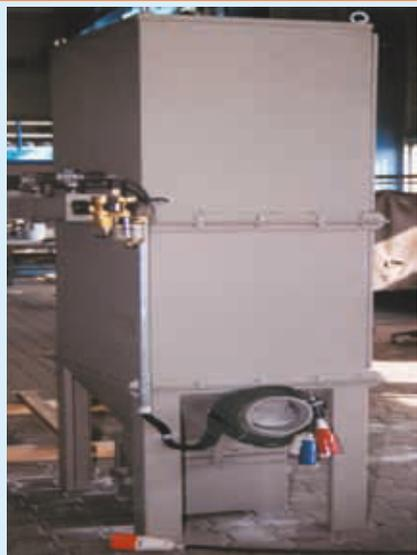
Стационарная установка производительностью 2.500 м<sup>3</sup>/час
