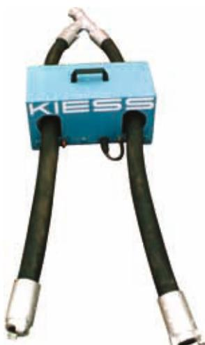
Нормы Германии ( BG VD26 ) предписывают необходимость прерывания струйного процесса не позднее 1 сек. после отпускания струйщиком рычага безопасности.
