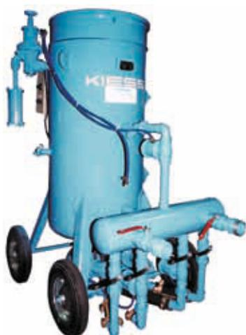
Такой котёл работает без прерывания процесса очистки при заполнении котла абразивом. Это особенно важно, когда требуется большая производительность струйных работ. Такой котёл имеет две одинаковые камеры, расположенных одна над другой. Нижняя камера постоянно находится под давлением. Верхняя камера служит для заполнения котла абразивом. После заполнения её, обе камеры работают как единое целое.
