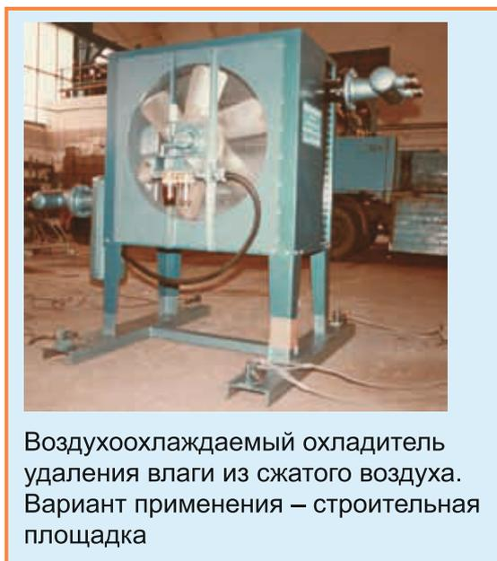
Воздухоохлаждаемый охладитель удаления влаги из сжатого воздуха. Вариант применения – строительная площадка
