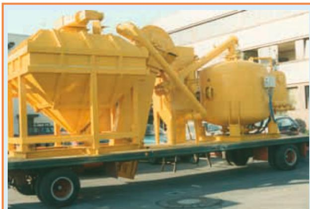
Мобильный вариант системы многократного использования абразива на трейлере, Вариант 1
