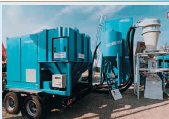
Всасывающая установка с циклонным автоматическим пылеотделением
