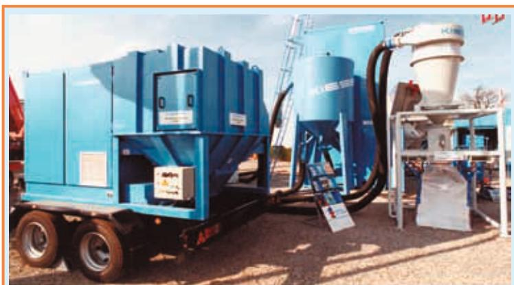
Всасывающая установка с вакуумным силосом и автоматическим пылеотделением.
