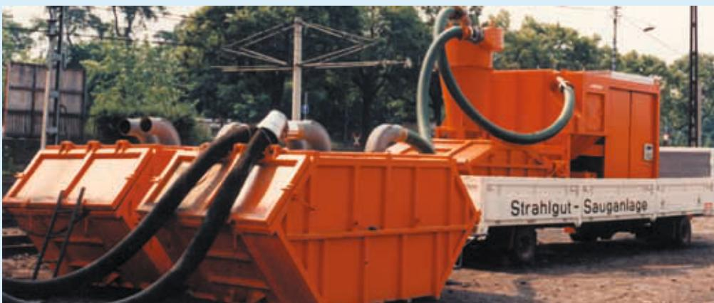
Всасывающая установка со сменными контейнерами отработанного абразива и циклонным пылеотделителем
